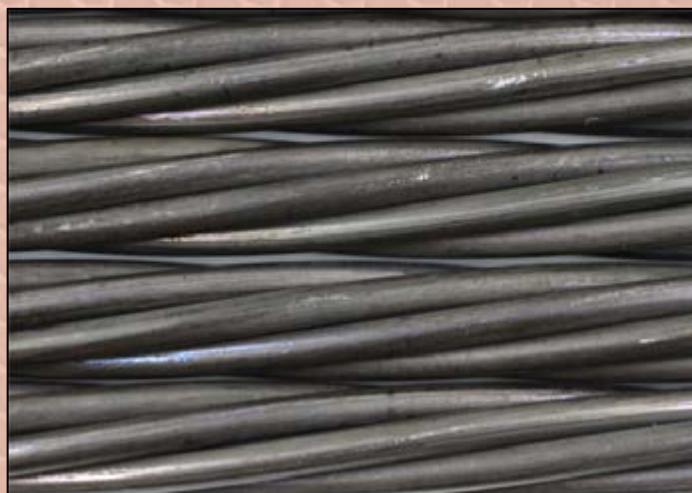
Disposición helicoidal alambres
